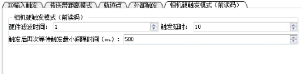
对相机的硬件滤波时间、触发延迟、触发后再次等待触发最小间隔时间进行设置。
